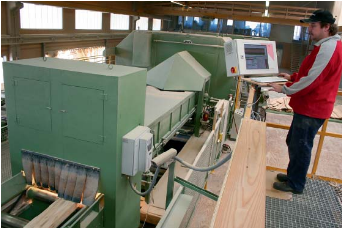
Modelerkennung vor Nachschnitt ist einfach zu bedienen; das Gehäuse zum ATB-Scanner wurde in Eigenleistung hergestellt
