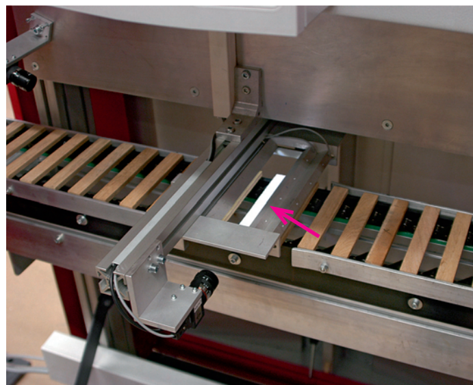
Lamellen laufen zur Qualitätssortierung an fünf Erkennungskameras vorbei – beleuchtet wird exakt mit Blitzlicht (s. Pfeil)
