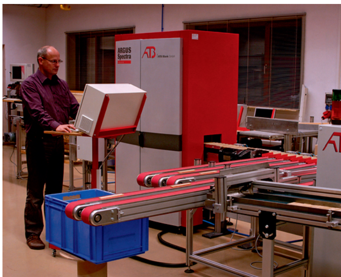
Georg Blank führt Argus Spectra vor: Im Vordergrund die roten Sortierbänder – rechts daneben das Förderband für das Industrieparkett
